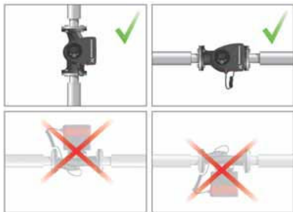
37. ábra Beépítési helyzetek
